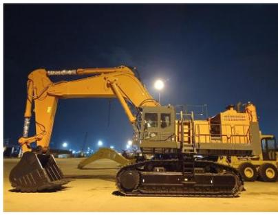
港大型貨物輸送の場合、分解をしたパーツ毎の輸送が必要になるケースがあります。特殊車両のトレーラー手配が必要な場合もあり、後工程に関わる作業が全く違ってくることもある為、製品形状ごとの輸送計画が重要となります。船積地に到着後ばらばらに運んだ貨物の組立作業を行い、約120tまで組みあがった貨物を細心の注意を払いながら自走させ船に積み込んでいきます。
